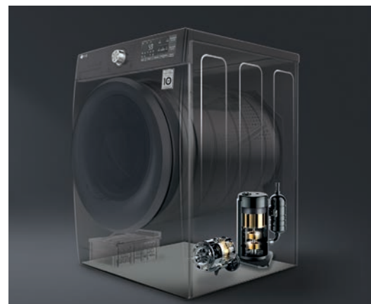
DUÁLNI TEPELNÉ ČERPADLO S INVERTOREM Pohled do nitra sušičky LG. V popředí invertorový motor sloužící k pohonu bubnu. V zadní části pak invertorový kompresor se dvěma válci.
