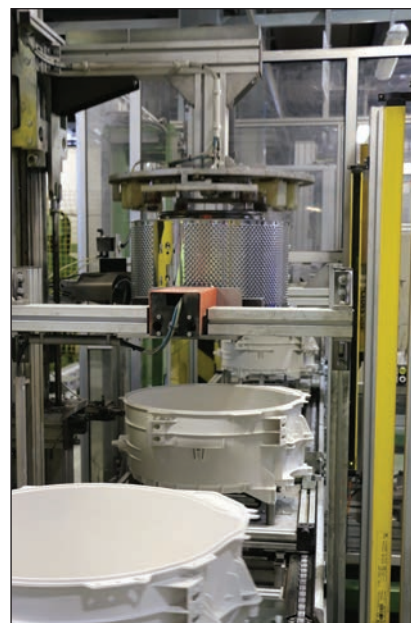
Zde už vidíme hotový buben s perforací, který je strojem vkládán do nádrže, aby společně utvořily prací agregát. Ten pokračuje na výrobní linku.
